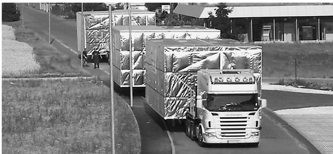
Transport der ADK-Module (OP-Anlage für St. Josefskrankenhaus Heidelberg).
